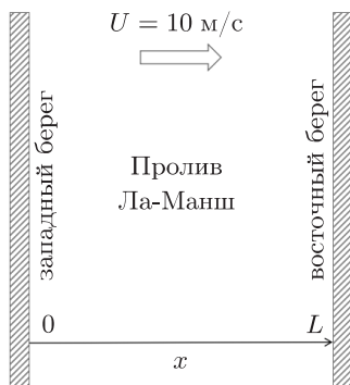
Рис. 1. Схематическое представление области моделирования в реальном пространстве. Постоянная скорость ветра в направлении оси разгона x равна U = 10 м/сек, ширина пролива L = 40 км.
